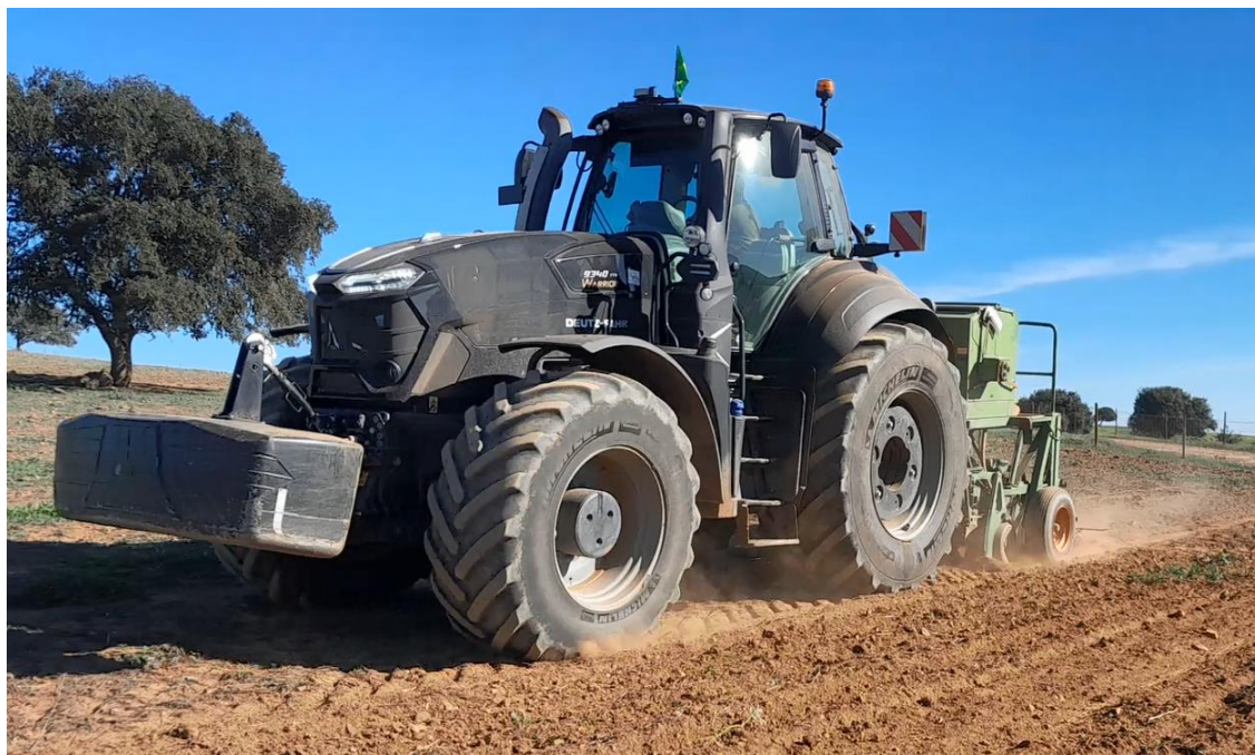
Figura 7: Conjunto tractor Deutz-Fahr 9340 330 cv + semeador direto Khun Metasa SDM 2217 3,5 m utilizado para sementeira direta (Imagem cedida pela ADPM).
